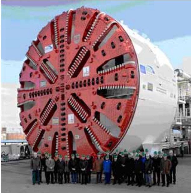
Abb. 2-8: Tunnelbohrmaschine der BEG (Quelle: BEG)
