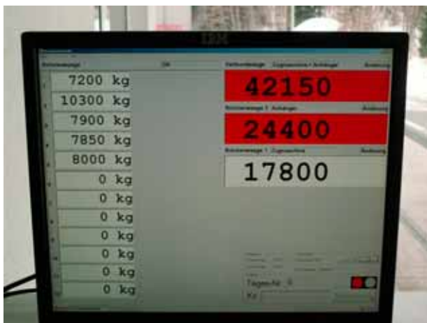
Abb. 1-23: Waagenanzeige eines überladenen Lkw
