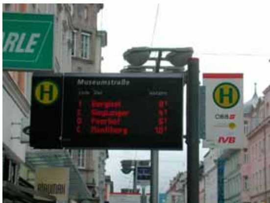
Abb. 1-30: Dynamische Fahrgastinformation der Innsbrucker Verkehrsbetriebe
