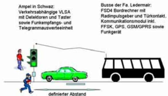
Abb. 1-28: Schemadarstellung VLSA- und Buskomponenten für den Pilotbetrieb
