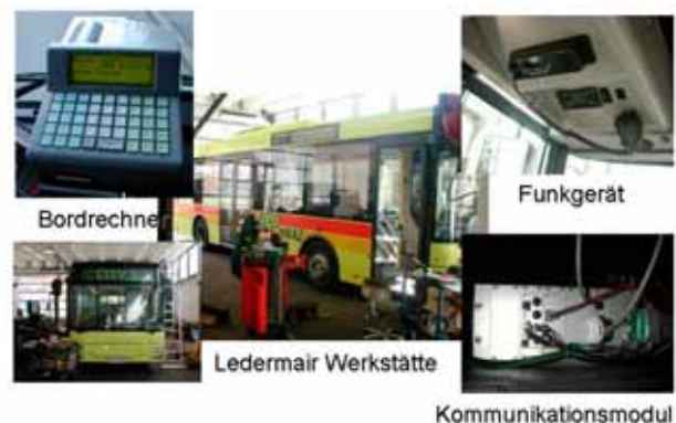
Abb. 1-29: Komponenten der Busausrüstung
