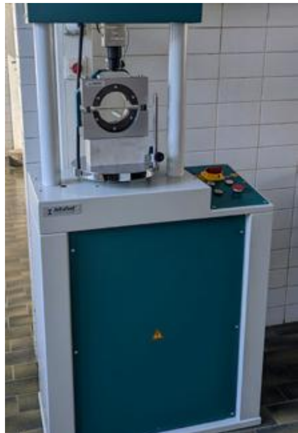
Prüfmaschine zur Überprüfung des Schubverbunds zwischen den Asphaltsschichten
