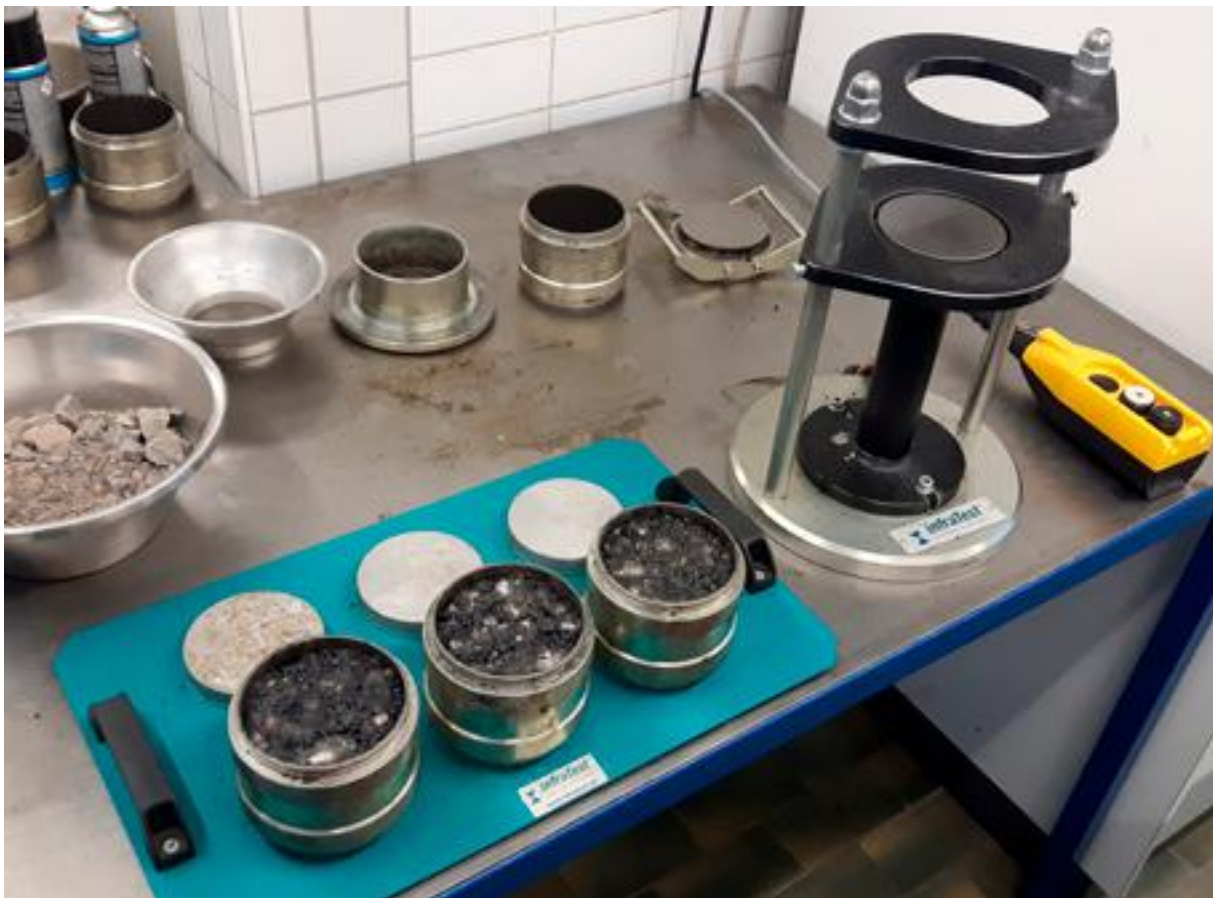
Asphaltmarshallkörper vor dem Auspressen aus der Form
