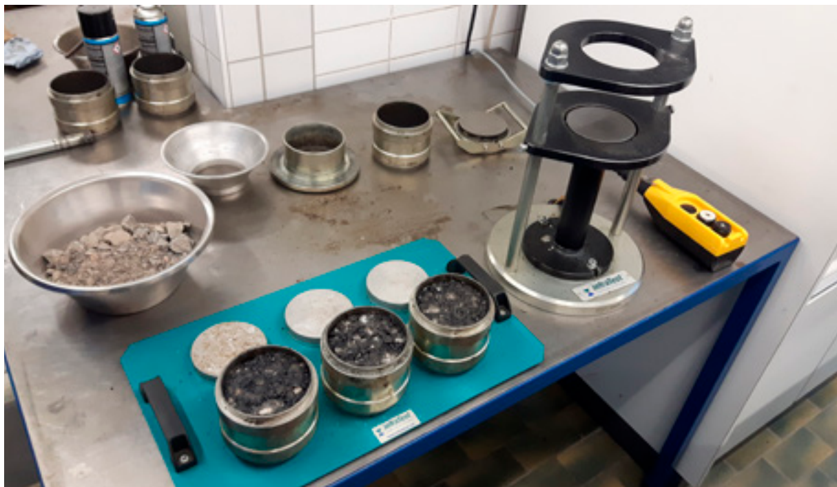
Asphaltmarshalkörper vor dem Auspressen aus der Form
