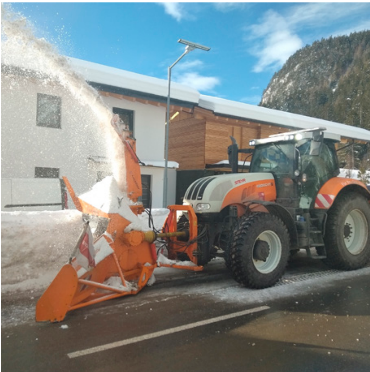
Die Seitenwallfräse befreit den Fahrbahnrand effektiv vom Schneewall. Der Antrieb der Fräse erfolgt dabei über die Frontzapfwelle des Kommunaltraktors.
