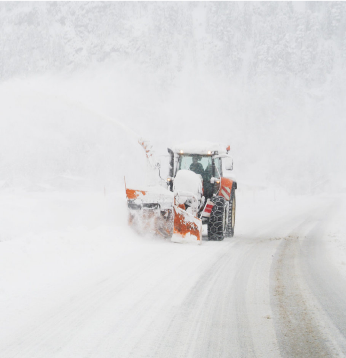
Die Seitenwallfräse befreit den Fahrbahnrand vom Schneewall.
