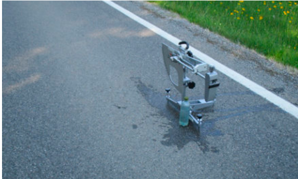
Griffigkeitsmessung des Asphaltbelages mit dem SRT – Pendel (Skid Resistance Tester)
