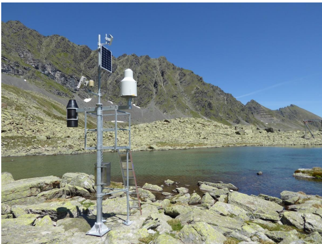
Messstelle für Niederschlag, Lufttemperatur und Schneehöhe, Datenfernübertragung; Foto: Hydrographischer Dienst, Land Tirol
