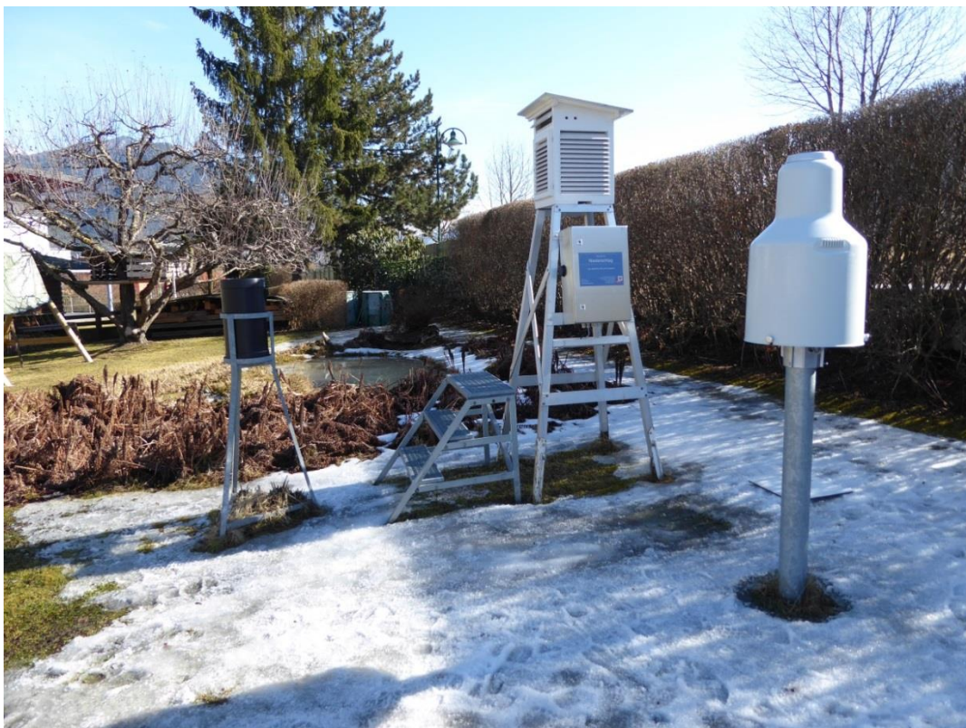
Vordergrund rechts: Niederschlagswaage (Ombrograph) Hintergrund, rechts: Wetterhütte - links: Niederschlagssammler (Ombrometer) Foto: Hydrographischer Dienst Tirol
