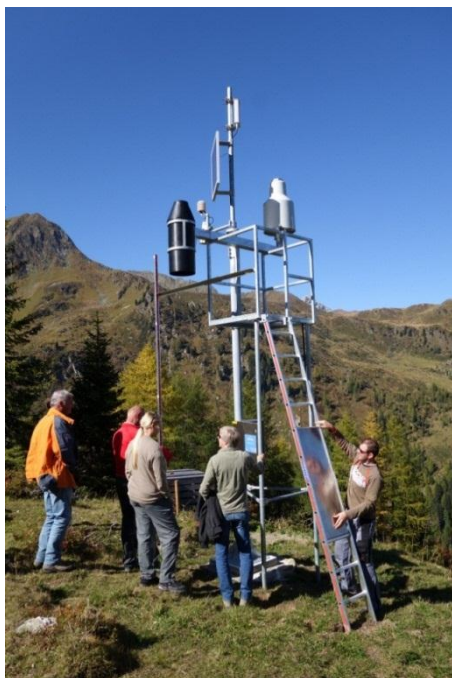
Inbetriebnahme der automatisierten Messstelle für Niederschlag, Lufttemperatur und Schneehöhe am Standort Porzehütte (1935 m)/Karnischer Kamm am 30. September 2014. Die Messstation mit Datenfernübertragung wurde von den hydrographischen Landesdiensten Tirol und Kärnten gemeinsam finanziert und vom Hydrographischen Dienst Tirol in der Gemeinde Obertilliach errichtet.
