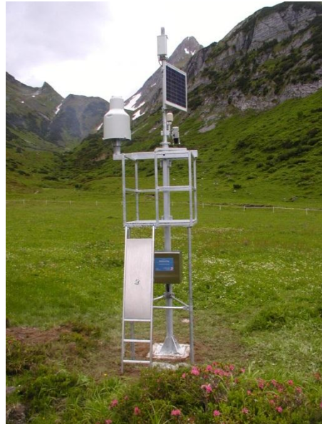
Die neu errichtete Messstelle (1845 m ü.A.) hinter dem Brandberg-Kolmhaus im Ziller Grund registriert Niederschlag (Waage), Lufttemperatur und Schneehöhe. Per GPRS werden die Daten laufend zur Zentrale nach Innsbruck gefunkt und sind über www.tirol.gv.at/hydro-online abrufbar. Die Stromversorgung erfolgt mittels Solarpaneel. Im Hintergrund: Brandberger Kolm, 2700 m
