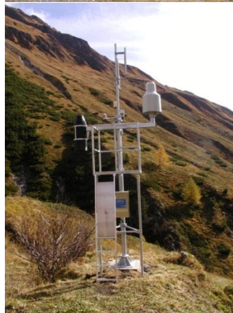
Jagdhausalm (2009 m), Gemeinde St. Jakob i. Deferegggen Testmessstelle für Niederschlag, Schneehöhe und Lufttemperatur
