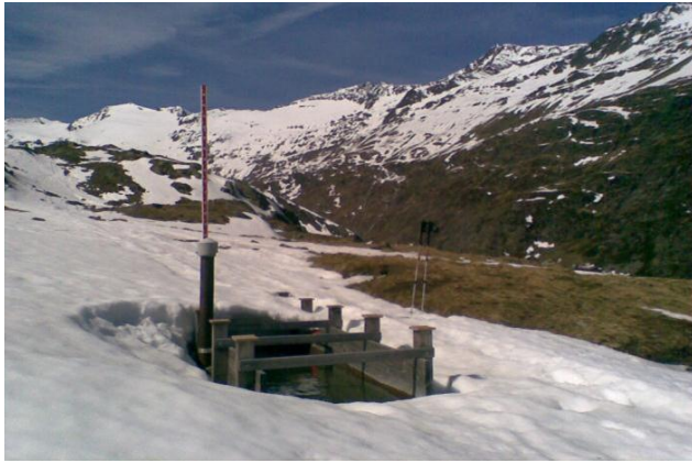
Messstelle für Wasserstand an der Hochebenkarquelle in Sölden/Obergurgl. Die Quelle wird vom gleichnamigen Blockgletscher gespeist. Die Messstelle (2220 m ü.A.) fällt etwa ab September trocken und muss jedes Jahr im Frühjahr unter dem Schnee ausgegraben werden.
