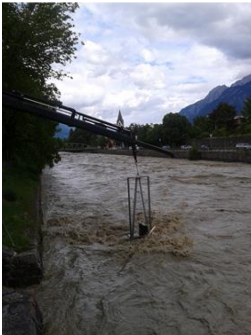
Geschiebemessungen an der Isel in Lienz bei Hochwasser am 31. Juli 2014. Nur mit größter Mühe konnte der Geschiebefangkorb entlang der Griesssäule nach unten gedrückt werden. Treibholz und die starke Strömung bei einem ca. 5jährigen Hochwasser machten der Probenahmemannschaft ziemlich zu schaffen.
