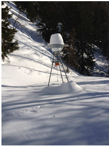
Probleme bei der Niederschlagsmessung im Winter (Totalisator Oberbergstollen im Halltal, 1610 m). An diesem abgelegenen Standort im Karwendelgebirge ist der Zugang im Winter häufig wegen Lawinengefahr nicht möglich.
