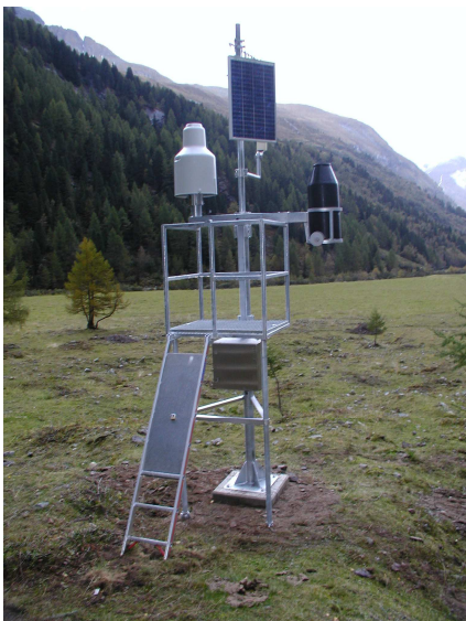
Anfang Oktober 2012 wurde der Totalisator Innergschlöß am Großvenediger/Osttirol aufgerüstet
