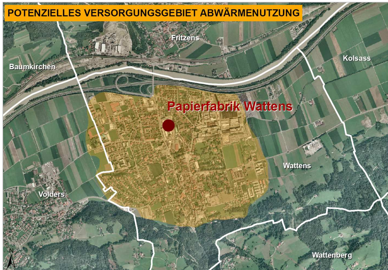
Abb. 77: Zwischenergebnis Beispiel potenzielles Versorgungsgebiet (50% Versorgung Niedertemperatur) am Standort Wattens – Abwärmenutzung der Papierfabrik Wattens (Darstellung: Wasser Tirol 2009)
