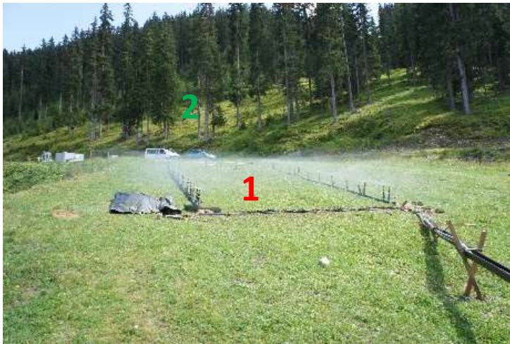
Abbildung 16: Istalanzbach: 1 Planierte Schipiste im Vordergrund \Psi_{\text{const}} = 0,83 bei Starkregen; 2 Aufgelockertes Baum-Altholz, Verjüngungsfläche mit dichter Zwergstrauchheide \Psi_{\text{const}} = 0 (kein Abfluss) bei Starkregen
