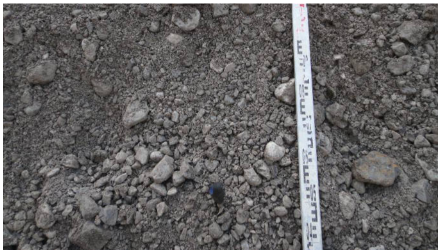
Abbildung 3: Typisches Aushubmaterial aus Geschieberückhaltebecken
