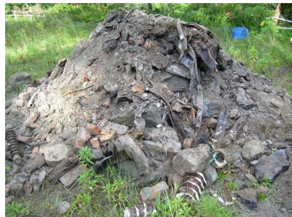
Abbildung 4 und 5: Baggerschürfe im Rahmen einer Deponie-Vorerkundung
