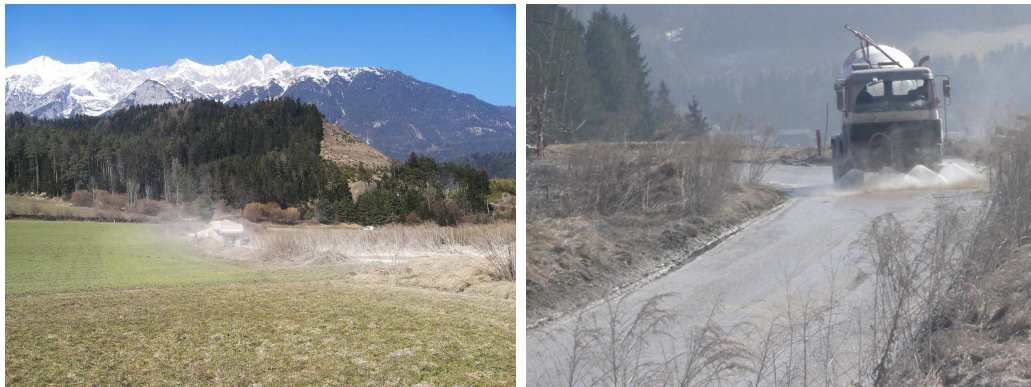
Abbildung 3.46: Diffuse Staubemissionen durch LKW - Fahrbewegung auf einer gereinigten (gekehrten) befestigten Fahrbahn (links). Befeuchtung durch Spritzwagen (rechts).
