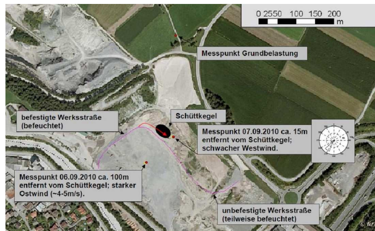
Abbildung 3.52: Emissionsmessung an einem Schüttkegel
