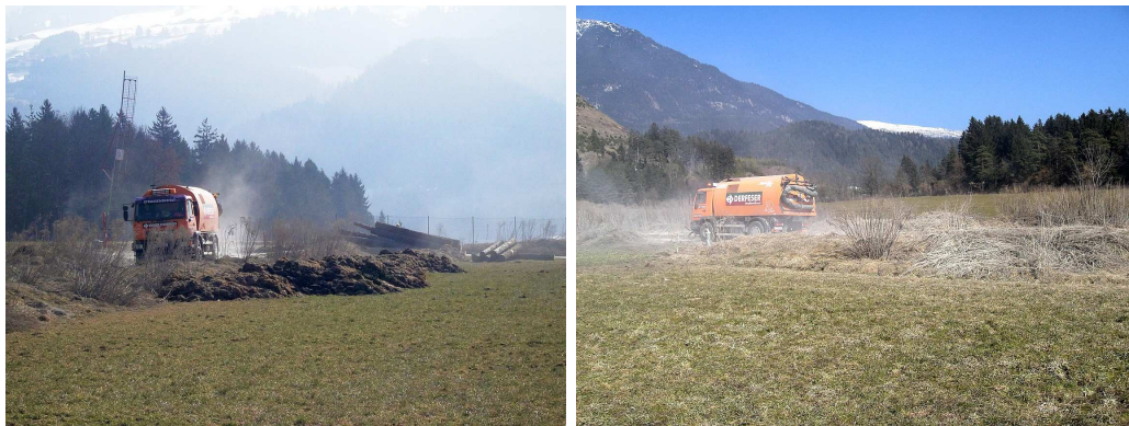
Abbildung 3.44: Diffuse Staubemission durch die Kehrmaschine
