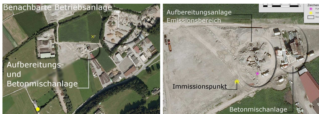
Abbildung 3.2: Übersichts- und Detailbild der Aufbereitungs- und Betonmischanlage I in Weer. Links: Die linke Ellipse markiert die Betriebsanlage. Die rechte Ellipse markiert eine östlich benachbarte Müll und Sortieranlage. Der gelbe Punkt markiert die Position der Grundbelastungsmessungen am 4.8 und 9.8.2010, der gelbe Stern am 14.10.2010 sowie 23.03.2011. Rechts: Detailbild der Aufbereitungs- und Betonmischanlage I in Weer.
