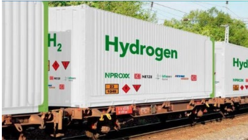
Abbildung 52: Beispiel eines 20“-Fuß ISO Wasserstoff-Transportcontainers in Kooperation mit DB © Schienentransport von Wasserstoff soll Standard werden (vogel.de) www.mm-logistik.vogel.de/schienentransport-von-wasserstoff-soll-standard-werden-a-954766/
