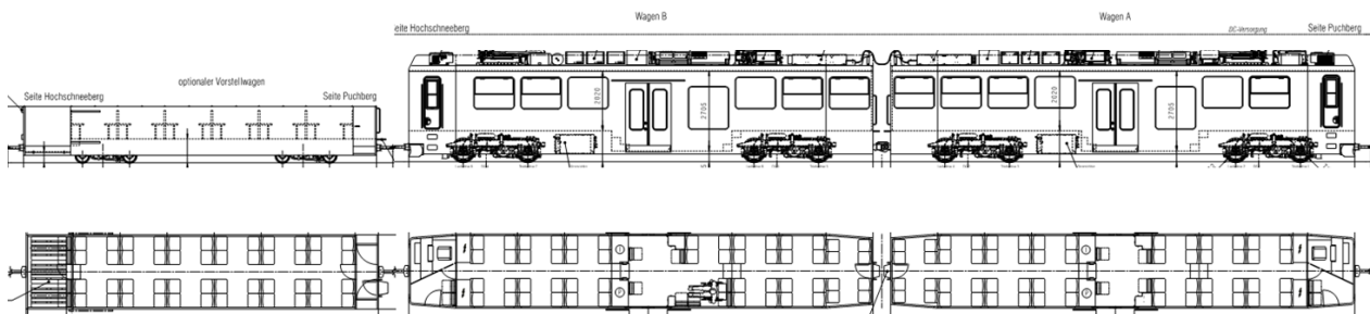
Abbildung 97: Fahrzeugkonzept dekarbonisierte Schneeberg-Zahnradbahn für 9t Achslast, [49] p7 bei 12,5t Achslast kann durch ein mittleres Jakobsdrehgestell der Niederfluranteil signifikant erhöht werden.
