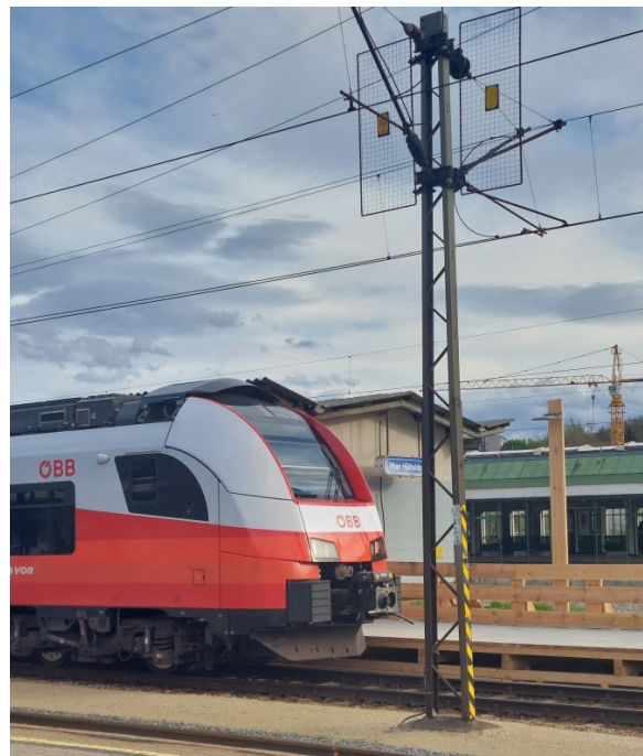
Abbildung 9: Modern Fahrzeuge (Baujahr ab 2016) unter Fahrleitung von 1952 Bhf. Wien Hütteldorf: Hauptgleise (Bst. 5) © 2024: MfV 20240404_174056
