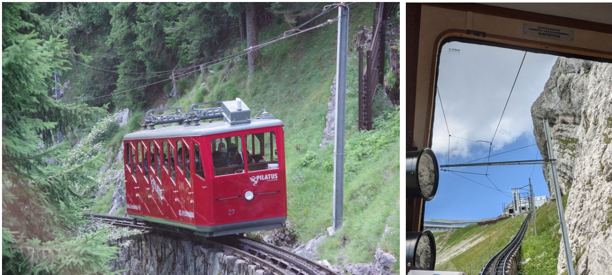
Abbildung 67: Windschiefe Fahrleitung zur Vermeidung hoher Mastdichten, Pilatusbahn bei Luzern © MfV 8177, Uzi
