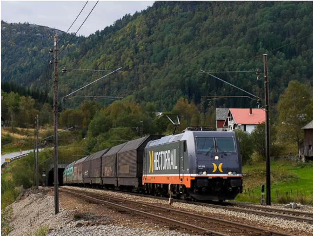
Abbildung 64: Weite Strecken der normalspurigen Hauptbahn Oslo – Bergen sind mit Holzmasten elektrifiziert mit Tragseil (Kettenwerk), 15kV 16 2/3 Hz und Geschwindigkeiten bis 130km/h, © www.blockstelle.de Jan-Geert Lukner
