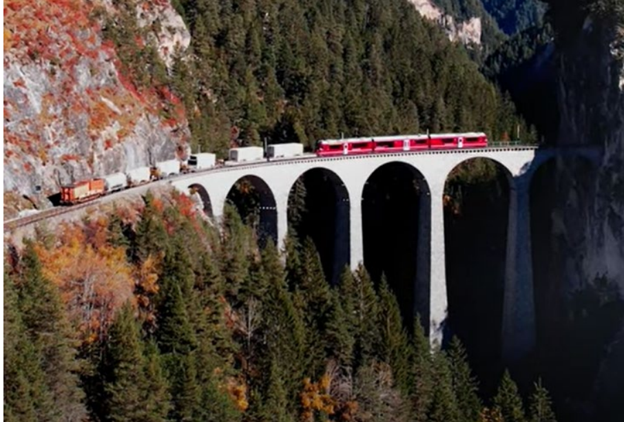
Abbildung 48: EMU-Triebzug ABe4/12 „Allegra“ der RhB als Triebfahrzeug eines Güterzuges (kein GmP oder PmG), © Kurt Wolfert, www.youtube.com/watch?v=Jgx64_Xfy8I , 2:51
