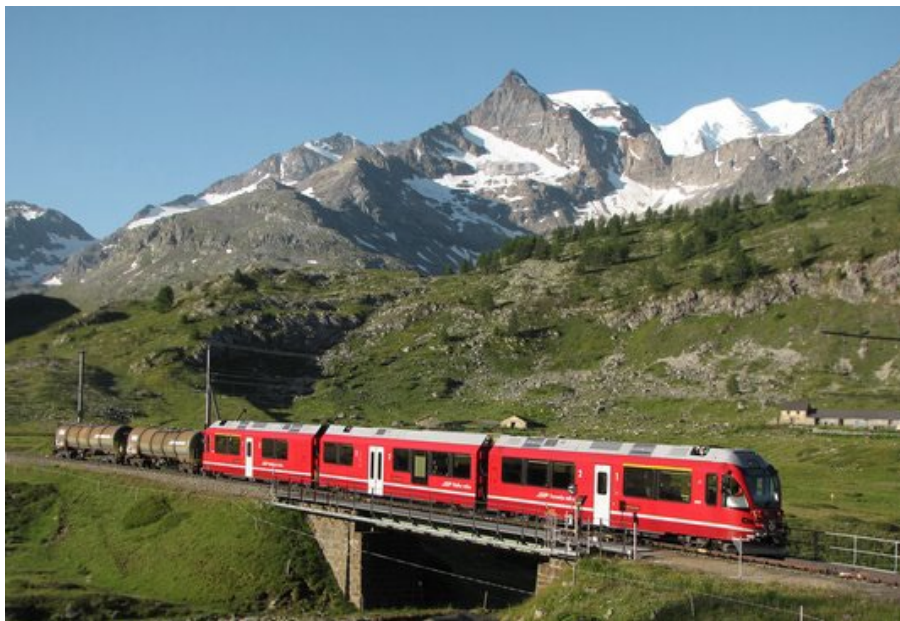
Abbildung 49: EMU-Triebzug ABe4/12 „Allegra“ der RhB als Triebfahrzeug eines Personenzuges mit Güterbeförderung (PmG) unter 1 kV = auf der Berninabahn, © internet
